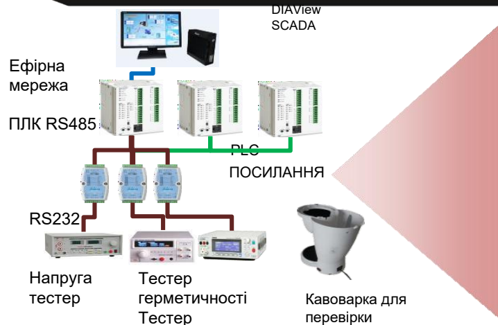
Структура системи виявлення кавоварки
