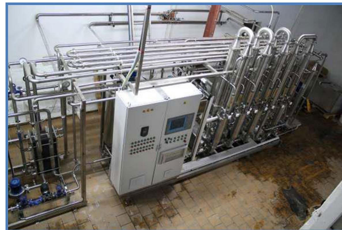
Мембранная ультрафильтрационная установка
