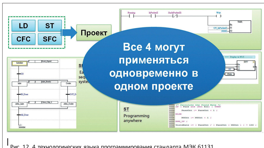
Рис. 12. 4 технологических языка программирования стандарта МЭК 61131.
