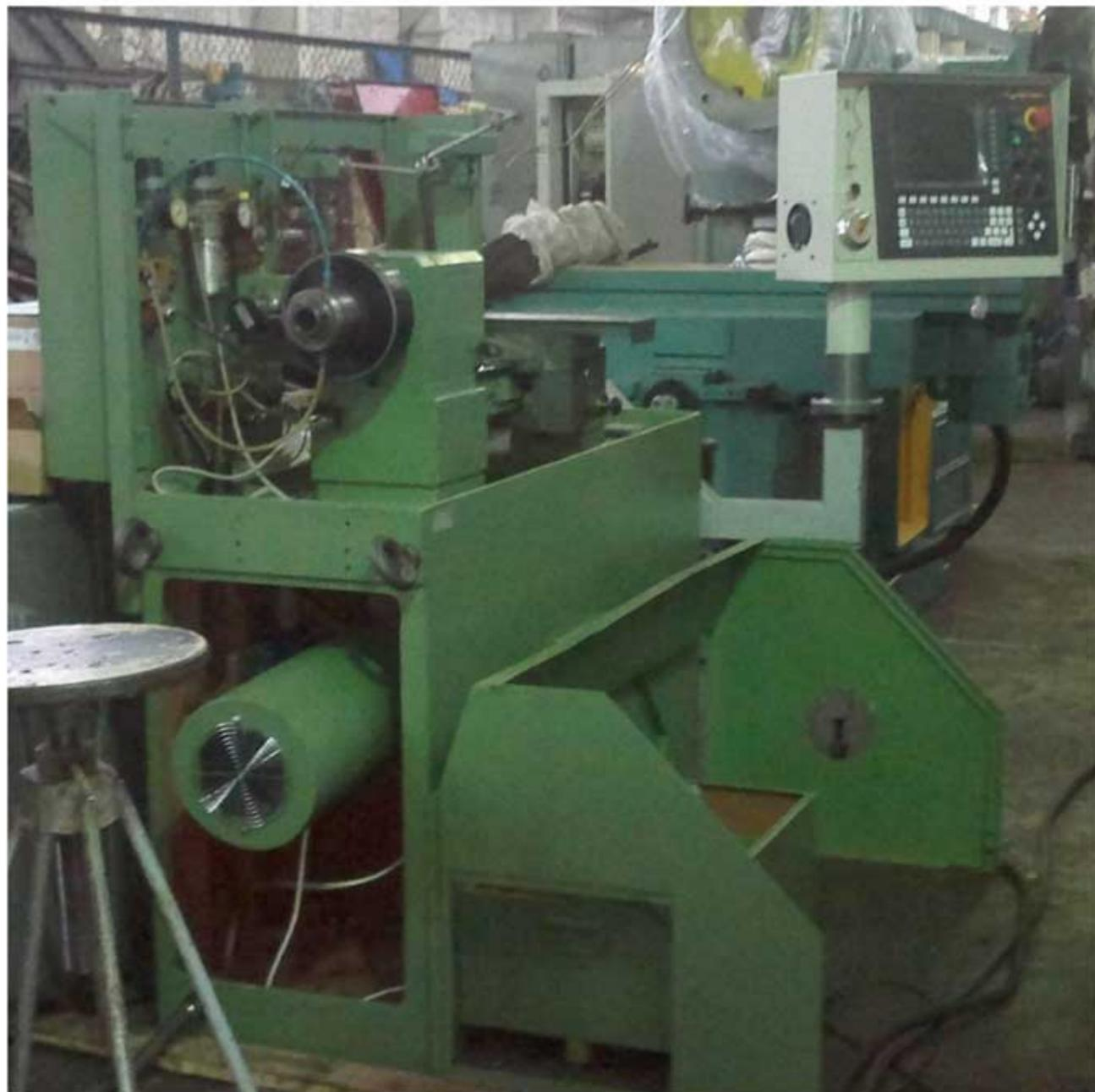
В ходе модернизации заменены приводы поперечного и продольного перемещения суппорта и установлен преобразователь частоты для бесступенчатой регулировки скорости шпинделя. В качестве базовых элементов модернизации системы управления использованы прекрасно зарекомендовавшие себя комплектующие **Delta Electronics**.
