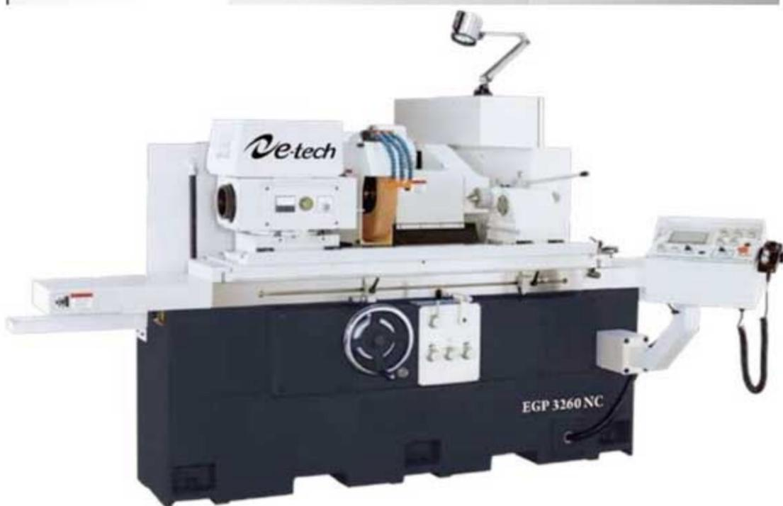
Сервопривод ASD-A2 или преобразователь частоты VFD-C2000 использован в приводе бабки изделия с регулировкой скорости
