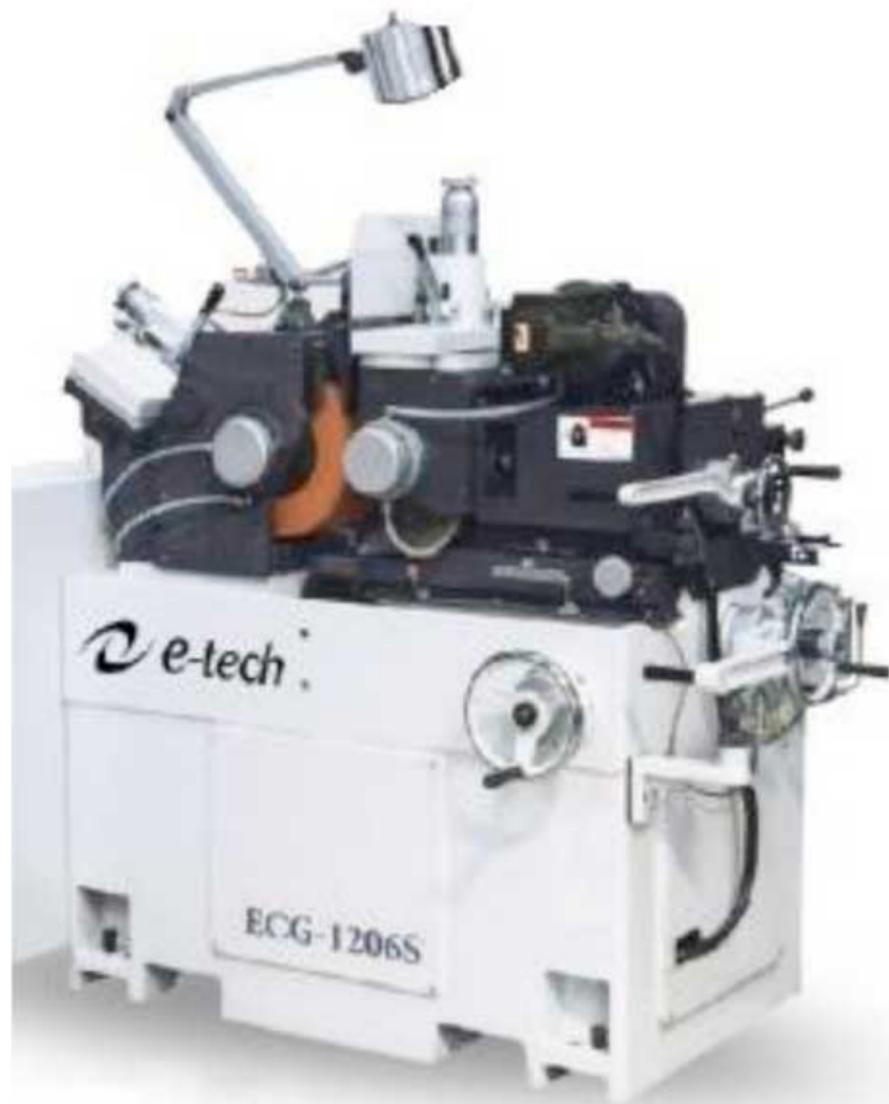
Общий вид бесцентрово-шлифовального станка фирмы E-tech
