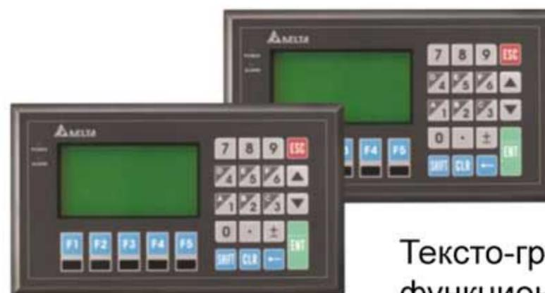
Тексто-графические панели с доп. функциональными кнопками
