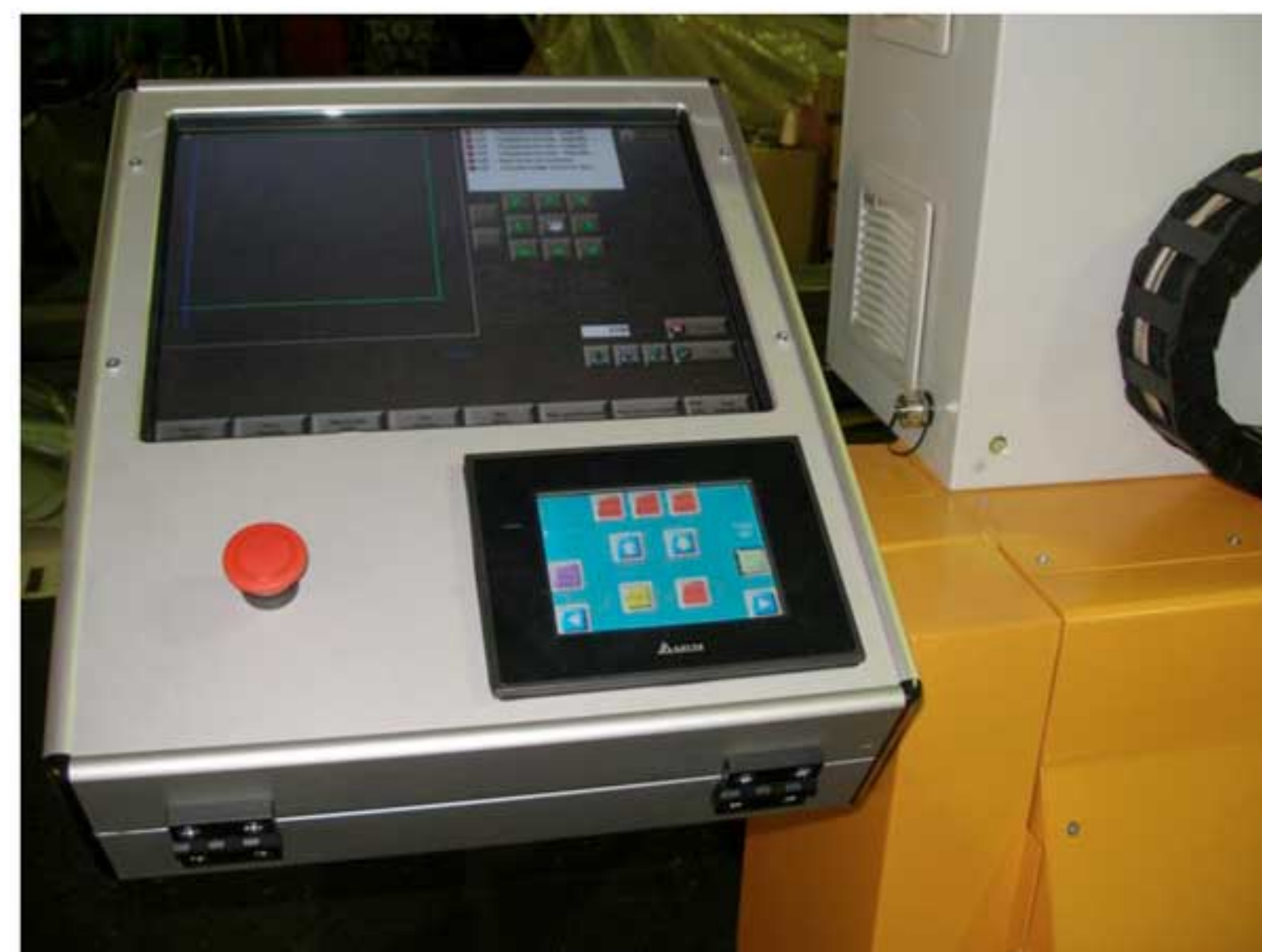
Пульт управления машиной MORAY с панелью Delta Electronics серии DOP-B в качестве вспомогательного пульта управления логикой машины
