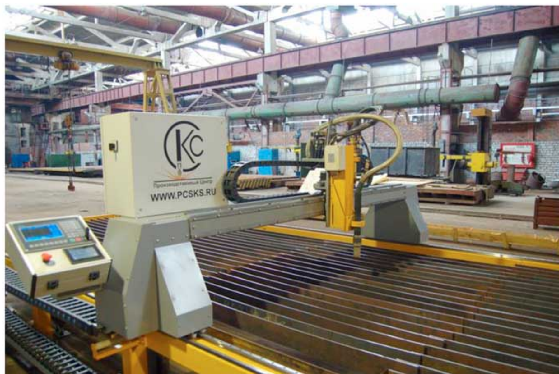
Машина термической резки DORADO (Дорадо) 1500x6000 FP. Сервоприводы Delta Electronics серии ASD-B2 и контроллер DVP20SX2
